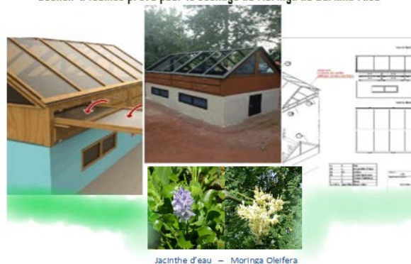
Séchoir à feuilles prévu pour le séchage du Moringa au Burkina Faso
